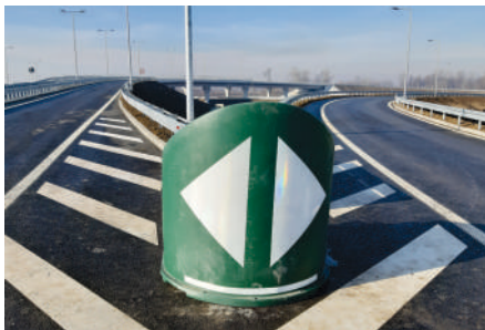
IX-5 Indikator vrha površine razdvajanja tokova
