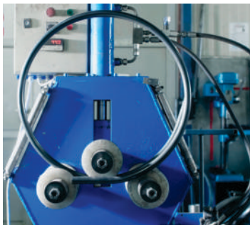
Savijanje cevi od 3/4" do 2.5"
