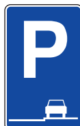
III-33.f Parkiralište na trotoaru, paralelno sa osom kolovoza, s desne strane puta
