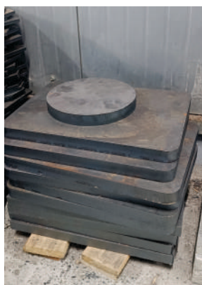
Primeri isecanje čeličnih ploča debljine 15 i 20mm
