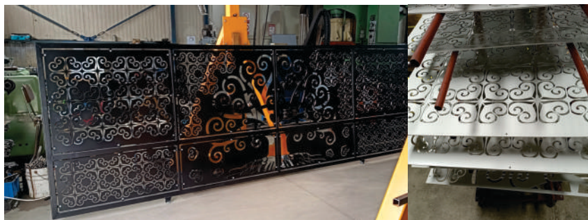
Primer isecanja aluminijumskog lima
