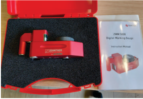
Merač debljine nanosa na asfalt
