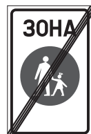
III-26.1 Završetak pešačke zone
