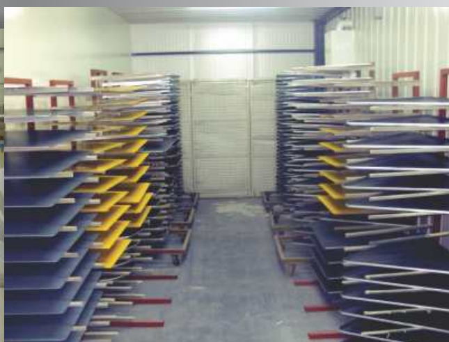
Komora za farbanje poleđine znaka
