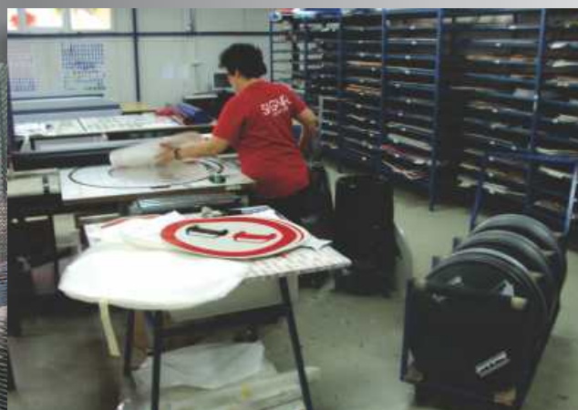
Apliciranje pripravljene folije na limenu podlogu
